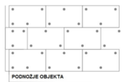
5 pričvršnica/ploča ili 8 kom/m 2 fasade
