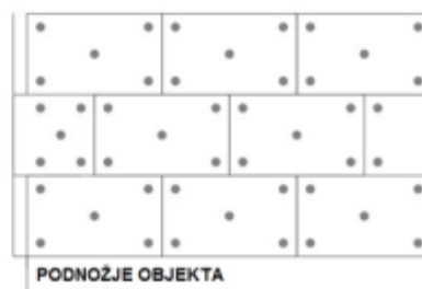
5 pričvršnica/ploča ili 8 kom/m 2 fasade
